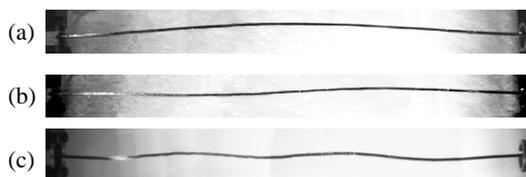
図3 変形速度を上昇させた場合にA7075アルミニウム合金製帯板に見られた座屈モードの変遷。(a) 準静的負荷 (b) 変形速度 0.075m/s, (c) 変形速度 0.6m/s).
