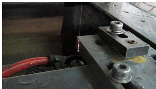
図 4. 中央に ADW が見え、オレンジ色の放電が確認される。
