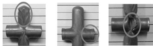
図5 初期肉厚0.5mmの銅管に生じた“しわ”など（シール押し量低減後(1.1mm)）
