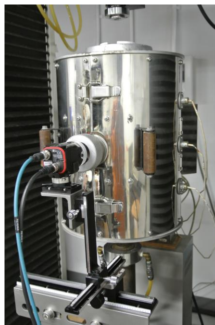
図3 石英窓付き電気炉と遠焦点カメラ
