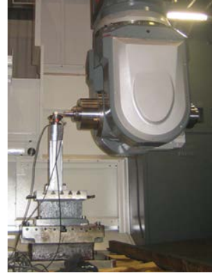
図3 主軸旋回形の5軸加工機でのR-test測定
