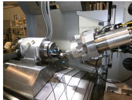
図8 旋盤形複合加工機での R-test 測定
