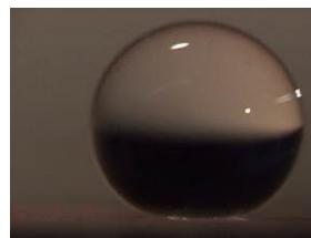
図1 HIREC板上の水滴
