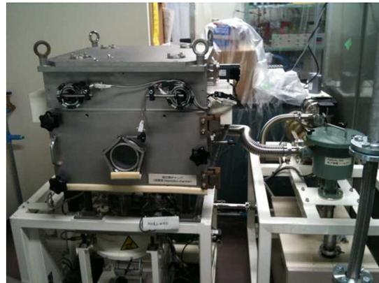
図 3 新たに導入された AD 法装置の外観
