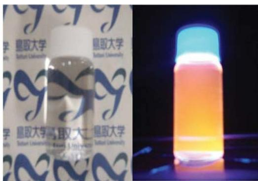
図 1.2 ZnS:Mn ナノ粒子の分散溶液 (左) と UV 光照射時の発光 (右)
