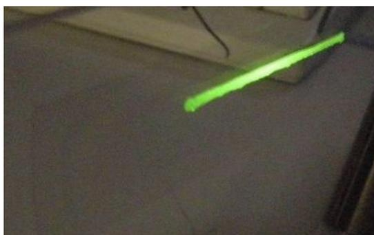
図 4(b) シースルーフレキシブル酸化物蛍光体薄膜 EL デバイス (発光時)
