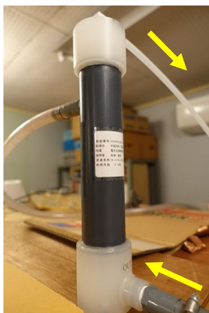
図4 気泡除去装置 (バブルカッター) 佐藤樹脂工業製、M-60
