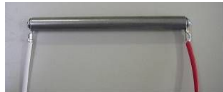
写真-1 分割鉄筋外観
