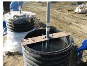
図-3 浸透実験用円筒水槽と水位計測器
