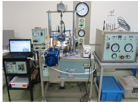
写真-1 透視型繰返し載荷リングせん断試験装置
