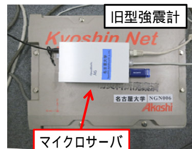
写真1 観測機器の外観 (上から撮影)
