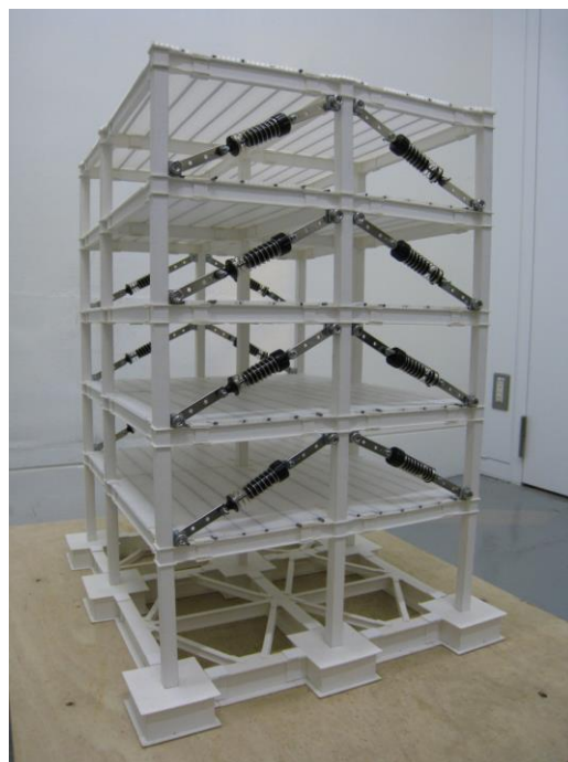
図4 鋼構造詳細模型による振動実験
