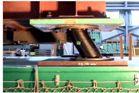
図1 免震構造の振動台実験
