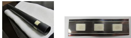
写真3 パイプ上周方向に等間隔で製作された 圧電薄膜超音波センサ
