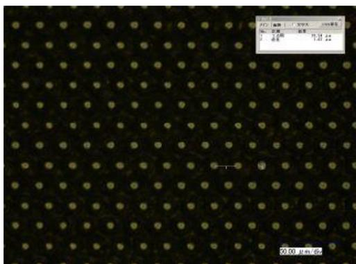
(b) 透過照明 穴径 7.1  $\mu\text{m}$
