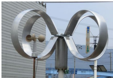
図8 アルミ円形翼バタフライ風車の実証機 ( D=2.06\text{m} 、 H=0.8\text{m} )
