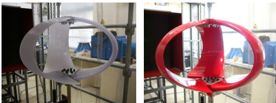
図4 実験用低重心風車、対称翼(光造形製: 白)とキャンパー翼(GFRP製: 赤)
