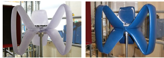
図6 実験用バタフライ風車、対称翼(光造形製: 白)とキャンパー翼(ビニロンFRP製: 青)
