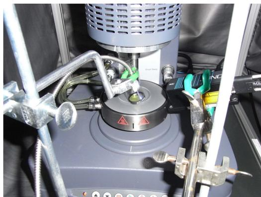
図 2. レオメータパラレルプレート上部に導入した光学系
