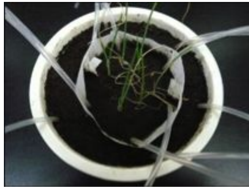
図1 30 \mu m のナイロンバックによって菌根区画と菌糸区画に分けられたコンパートメントポットと土壌中に埋設された土壌溶液採取管
