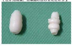
力学的特性についても、チューブ状の組織を積層化することによって破断強度は上昇することが確認された(1, 2, 3 layers:一層、二層、三層のチューブ状の組織、artificial Trachea:人工気管、native Trachea:成ラットの気管)。三層のチューブ状の組織、及び、人工気管では成ラットの気管と同様に計測器の測定限界である50gの負荷でも組織が破断しなかった。
