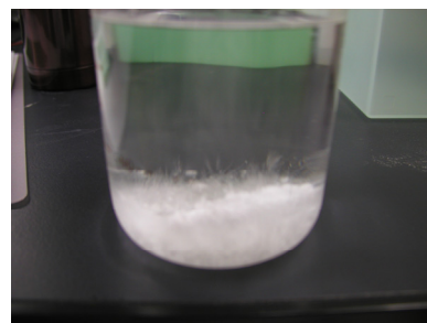
図 1. 鎖長 65 のポリリン酸ナトリウム
