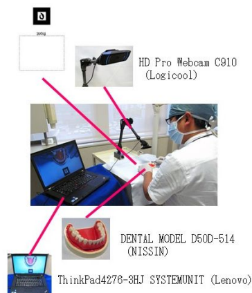
図1. モデル1を用いた「支台歯形成 AR ナビゲーション」の全容
