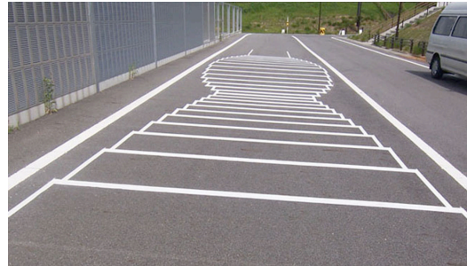
図3: イメージハンプの走行実験模様 (積水樹脂滋賀工場)
