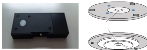
図2：極微弱LED光源と、これを積分球で測定するための専用ポート
