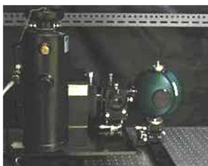
図1：発光溶液などの微弱な光子を測定するための積分球式分光測定システム
