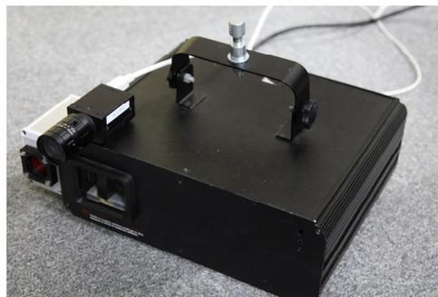
図1. 高速カメラ・レーザシステムのプロトタイプ
