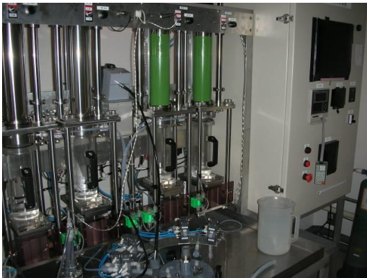
写真 1 使用した原子核乳剤製造装置
