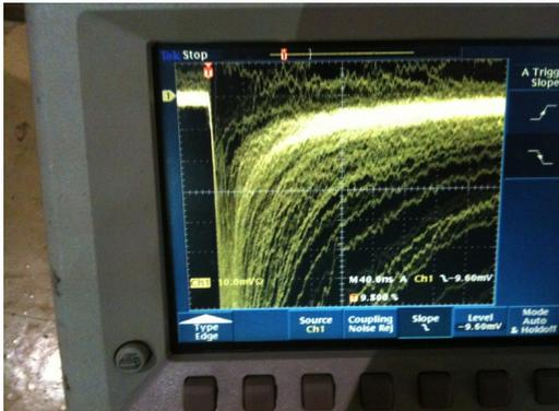
動作の安定性を確認した。上のオシロスコープの写真から、ビーム中でも大きなゲイン低下が見られず、かつ低エネルギー領域にも大きなレート寄与がないことが分かる。ガス検出器では100eV程度の僅かなエネルギー損失にも感度があるので、通常気にならない低エネルギーのX線などにも影響されるが、実際のビーム中での環境でも
