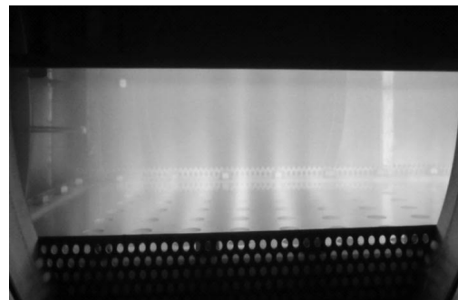
図2: 400kHz, 100W投入時のアルゴンプラズマ生成の様子。
