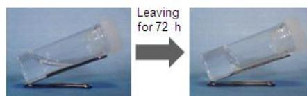
図 2 ゾルーゲル転移過程における超分子ポリマー水溶液の外観
