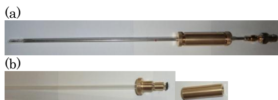
図2 温度可変電流/電圧検出 ESR 用に自作したプローブの写真。(a)自作プローブ、(b)分解写真 (Oリングによる断熱真空の保持部分)
