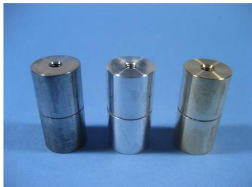
図3 各種金属接着試験片
