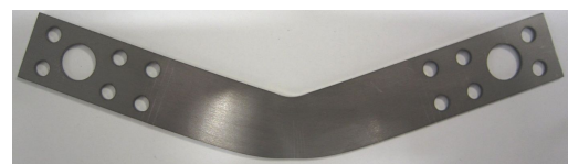
図3 引張り曲げ試験後の試験片
