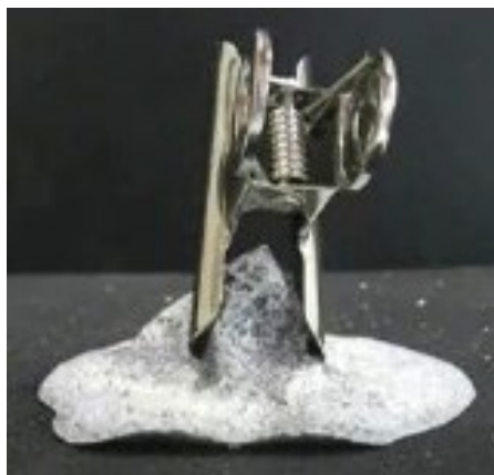
図1： 磁性スライムによる作業移動ロボットの固化の様子
