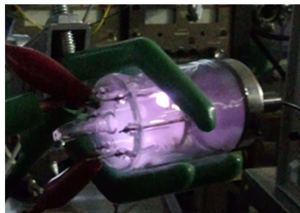
図2 スルーホール型ナノチューブ電子エミッタ真空管試作デバイスの動作試験の様子
