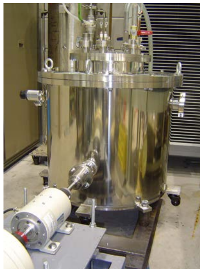
図1 試作機試験用の液体窒素冷却クライオスタット外観写真
