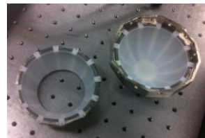
図 13 アウトロータ型三自由度アクチュエータの試作
