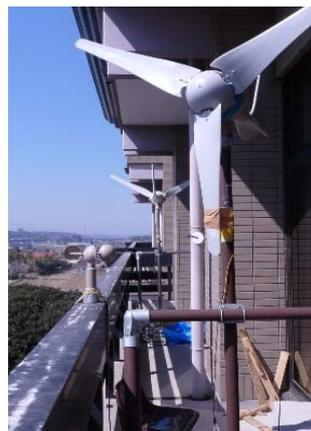
【図9 設置した小型風車と風速計】
