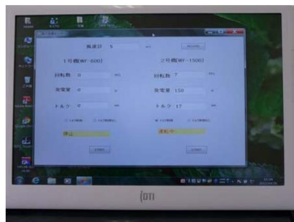
【図10 風力発電モニターパネル】
