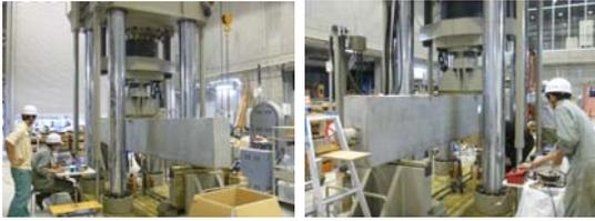
コンクリート試験体の荷重試験
