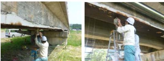
鋼板接着補強したコンクリート桁の現場試験
