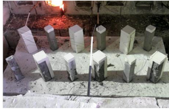
図5 加熱後の角柱試験体の損傷状況
