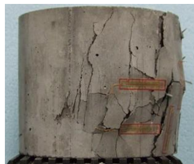
図2 外周圧縮実験における破壊状況の例
