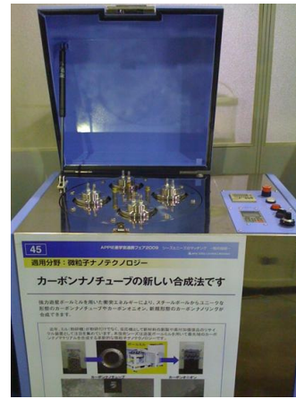
図3 高速遊星ボールミル装置
