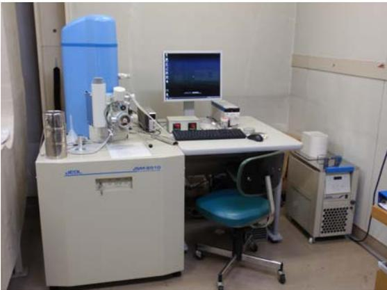
写真1 粒子の構造観察に使用した、凍結した試料の調査を可能とする低温走査型電子顕微鏡 (Cryo-SEM)
