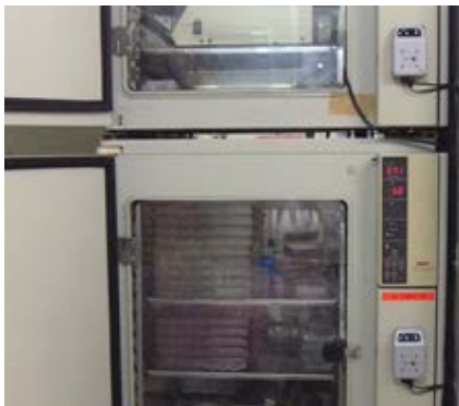
(図2) インキュベーターへの ucode タグリーダの設置
