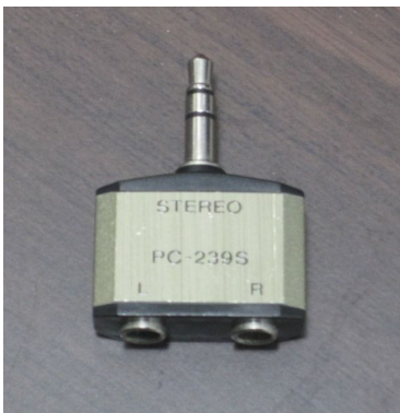
(図6. 2本のモノラルマイクロフォンをボイスレコーダーの2チャンネル端子へ変換入力した)
