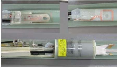
図2 HMQCのための $^1\text{H}$ - $^{13}\text{C}$ 二重同調検出コイル。T/R制御可能な $^1\text{H}$ 用外径60mmの送信用容積コイル(図下)、直径15mmの受信用表面コイル(図左上)を導入し、これに自作の $^{13}\text{C}$ 表面コイル(図右上)を組み合わせ、マウス脳用RFコイルを製作した。
