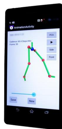
図4. 加速度センサを利用した、スマートフォン内蔵型転倒リスク/歩行評価装置
