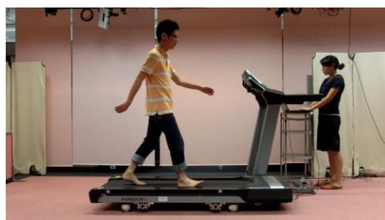
図3. カセンサを利用した転倒リスク/歩行評価装置
