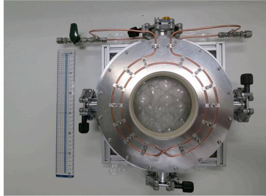
図 4 二次粒子強度モニタ用 CT 試作機
