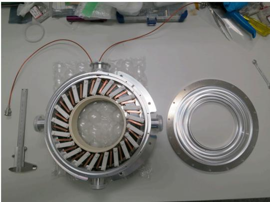
図 3 セラミック製内筒と、アルミ製筐体 (コアを固定するセラミックと密着する)
