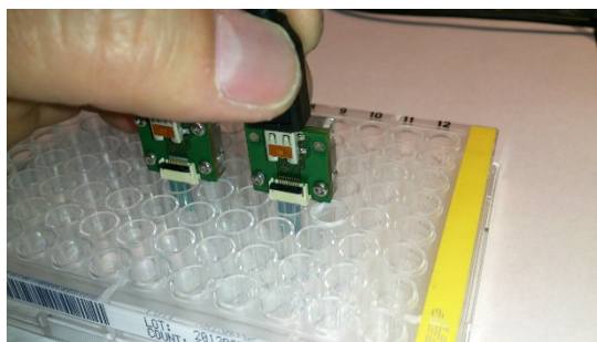
図4 両面被覆法を応用した、特殊な装置を一切使用しない素手によるセンサーチップの被覆・測定の様子。この写真のように 96 穴プレート等を利用した標準プロトコルが適用可能になった。
