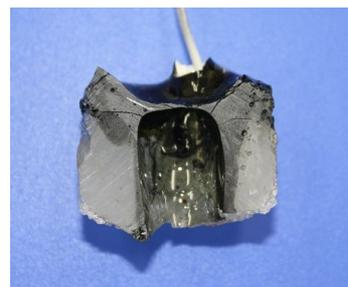
図 8 溶融実験後の内管内部のガラスの切断面
