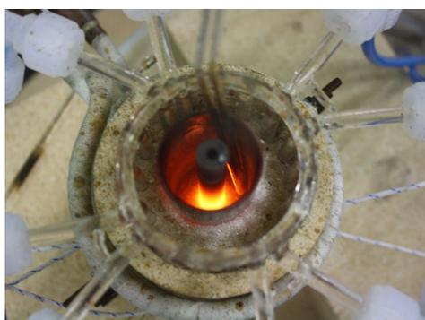
図 6 模擬廃液滴下中の溶融の様子
