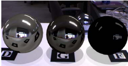
図1 拡張現実感の合成画像(反射率の異なる鏡面球のバーチャルオブジェクトへの写り込みが再現されている例:しかし、映り込んだ窓の外の映像は白とびし、球が落とす影の境界は鮮明で写実性が低い)
